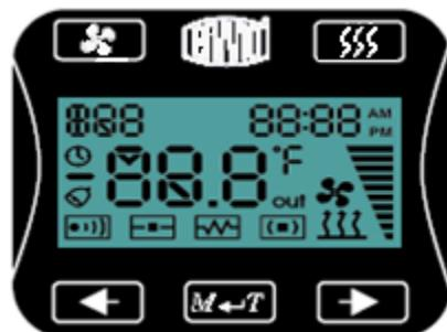
**[fan]** - zapnutí či vypnutí větrání,
